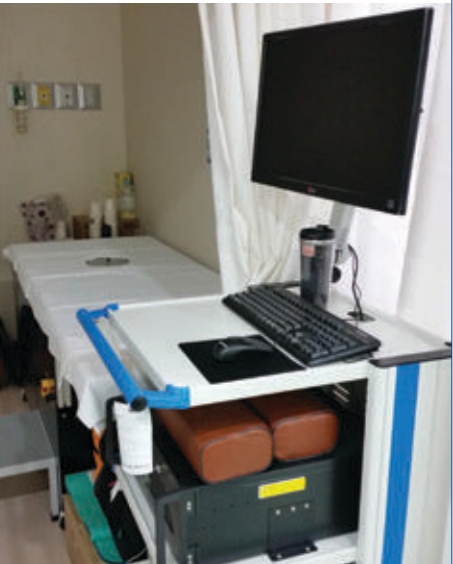
서울대병원에 설치된 마이크로파 유방암 진단 시스템
