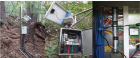
산사태 신속탐지 모니터링 시스템(지리산)
