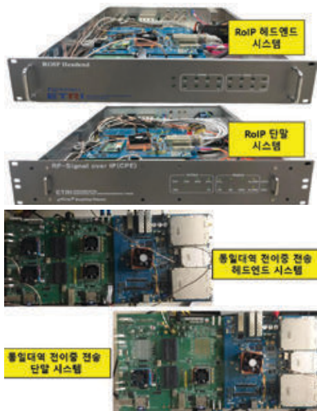
RoIP 헤드엔드 · 단말 시제품(상), 동일대역 전이중 전송 헤드엔드 · 단말 시제품(하)
