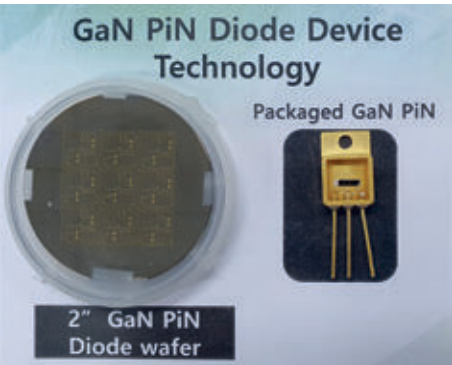
ETRI 연구진이 개발한 수직형 질화갈륨(GaN) 전력반도체기판(웨이퍼)과 질화갈륨(GaN) 전력소자가 패키징된 모습(우측)
