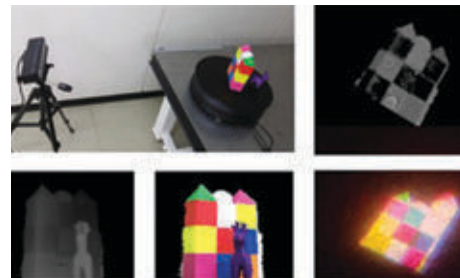
홀로그램 획득 장치 및 고속 생성 결과
