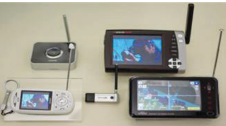
지상파 DMB 수신 SoC 및 본 기술을 적용한 DMB 단말기
