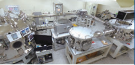
레이저 기반 다중입자(양성자+전자) 발생 장치
